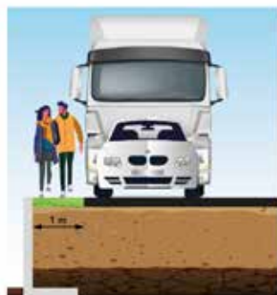
LVF-GAMMA zwaar verkeer, gelijkmatig verdeelde overlast volgens NBN EN 1991-2
