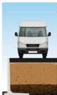
DLF10GSZ gelijkmatig verdeelde overlast 25 kN/m 2
