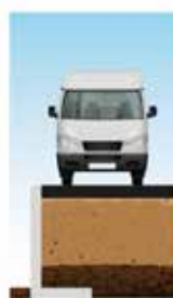
DLF10GS gelijkmatig verdeelde overlast 25 kN/m²
