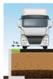
DLF10GS gelijkmatig verdeelde overlast 40 kN/m² op randafstand 1 m equivalent aan belastingsmodel LM1 volgens NBN EN 1991-2
