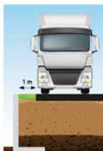
DLF10GS gelijkmatig verdeelde overlast 40 kN/m 2 op randafstand 1 m equivalent aan belastingsmodel LM1 volgens NBN EN 1991-2
