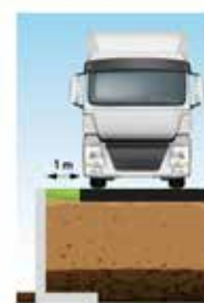
DLF10GS charges standard 40 kN/m² à une distance de 1 m du bord équivalent du case de charge LM1 selon NBN EN 1991-2
